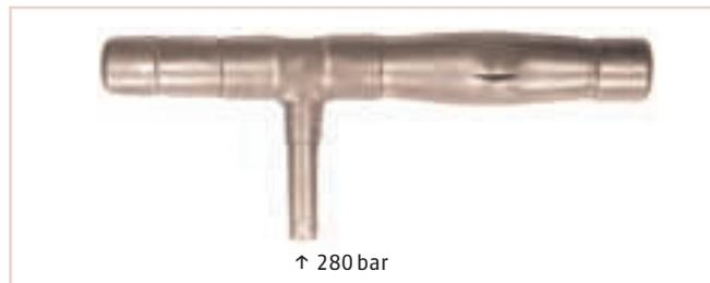
**Bild 12:** Weichgelötete Kupferrohrkombination, Abmessung: 22 × 1 mm, nach einer Berstdruckprobe von 280 bar (Deutsches Kupferinstitut A 1063)
